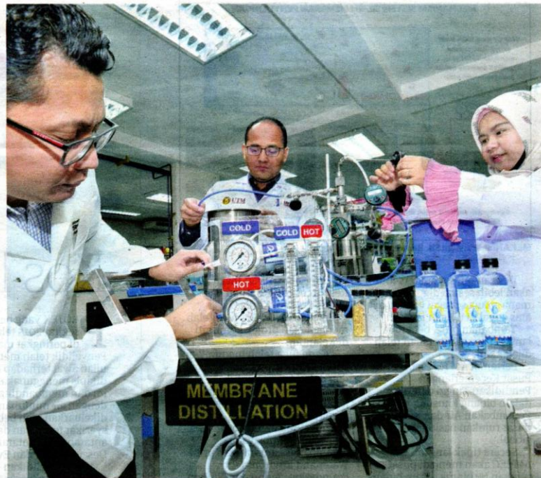
DR. MOHD. HAFIZ DZARFAN OTHMAN (tengah) dan penyelidik bersama menyelenggara sistem penyulingan membran bagi proses penyahgaraman air laut.
