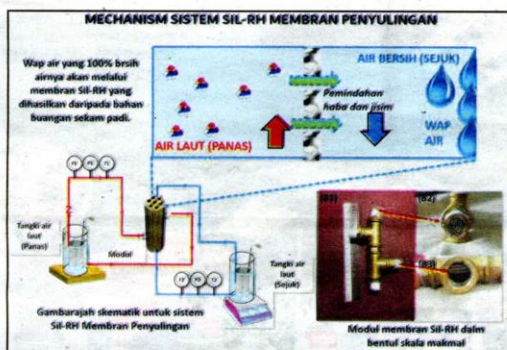
MEKANISME sistem SIL-RH membran penyulingan.
